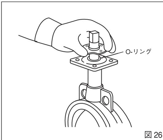
7.O-リングの挿入：弁体上部から上部弁棒にO-リングを挿入し、シリコンオイルを塗布します。次いで、上部弁棒に設けられた溝に、抜け止めブッシュをはめ込みます。
