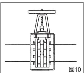
S. 粉塵、降雪、周囲温度が60°C以上等の環境の悪い場所でバルブを使用する場合は、事前に弊社へご相談ください。特に粉塵のひどい場所では、バルブの弁棒、プレート等に粉塵がかからないようにカバーをしてください。
