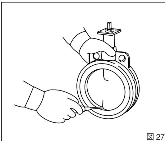
9.弁体内の空気抜き：皿小ねじのセット後、本体、シートリング間に封入された空気を、マイナスのドライバーなどで抜きます。(図27)
