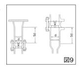
P. バルブの前後にレジューサーがあり、配管口径が急激に拡大・縮小する場合、付近に発生する乱流のため、弁体のばたつきや振動、騒音などのおそれがあります。このような場合、レジューサーとの間にバルブ呼び径の5倍以上の距離を確保してください。(図9)
