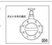
L. 配管ボルトの締め付けは、安全に作業を 行う為にできるだけメガネレンチを使用 してください。尚、通常のスパナ等でも 可能です。
